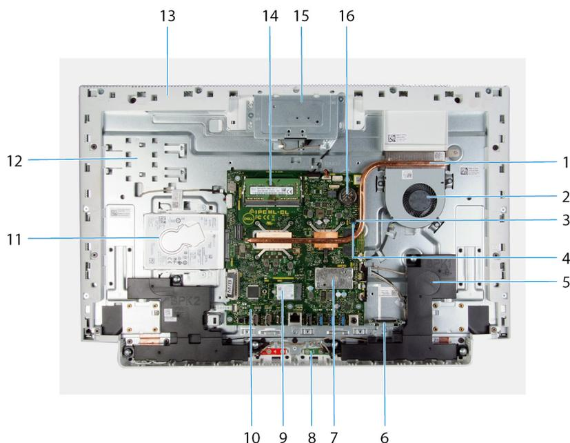
1. dissipador de calor
