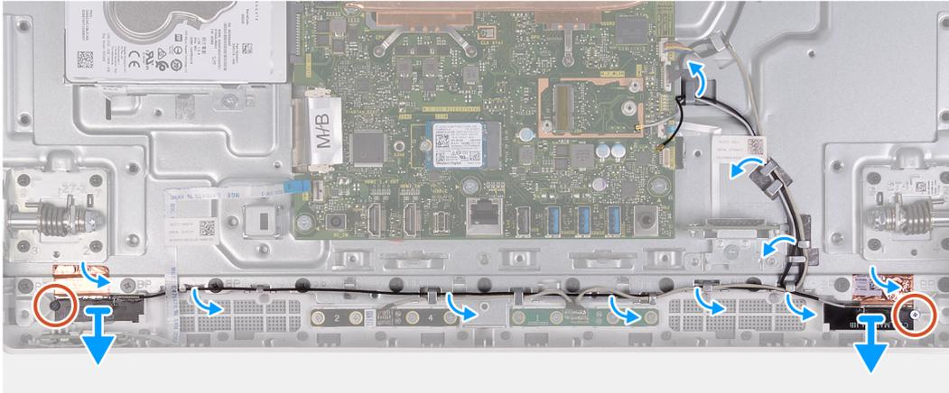
**NOTA:** Anote o roteamento dos cabos da antena antes de remover os cabos da antena das guias de roteamento. Além disso, observe a localização dos módulos da antena impressos na base do conjunto da tela como ANT-B (preto) e ANT-W (branco).
